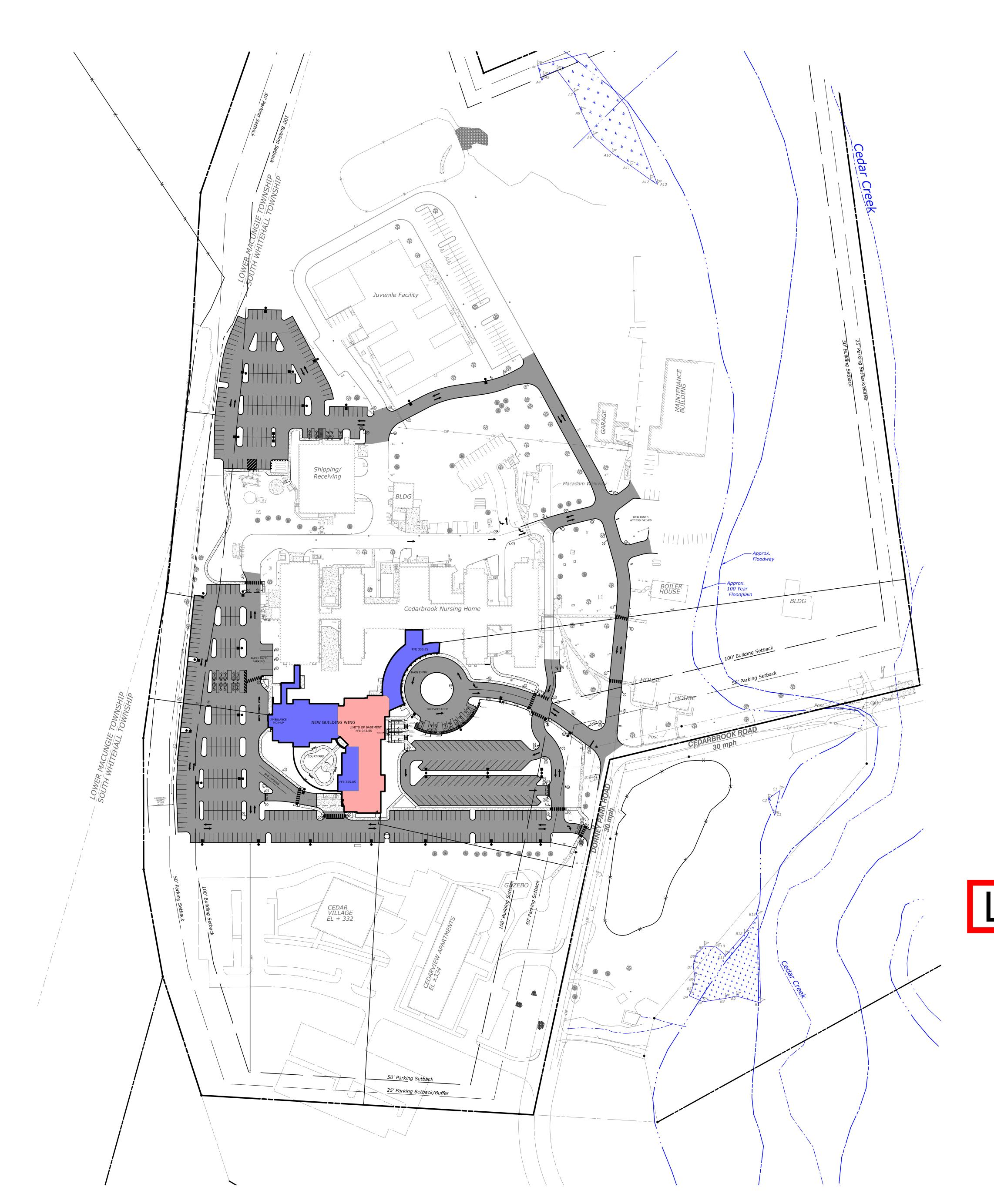
**LEGEND** PROPOSED SITE FEATURES BUILDING LINE CONCRETE SURFACE —— EDGE OF BITUMINOUS PAVEMENT STANDARD DUTY PAVEMENT POROUS PAVEMENT PAVEMENT OVERLAY HEAVY DUTY PAVEMENT PAINTED STRIPE TRAFFIC ISLAND ———— EDGE OF ROADWAY SHOULDER ———— EASEMENT LINE - BUILDING SETBACK IRON PIN PROPERTY CORNER MARKER CONCRETE MONUMENT PROPERTY CORNER MARKER MAG NAIL PROPERTY CORNER MARKER \_ EDGE OF CRUSHED STONE OR GRAVEL SURFACE NON-CONCRETE WALKWAY CF——— CONSTRUCTION SAFETY FENCE
